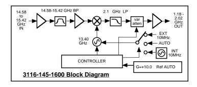
FIGURE 1.2 3116-145-1600 Block Diagram
