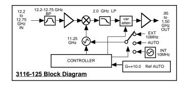
FIGURE 1.2 3116-125 Block Diagram
