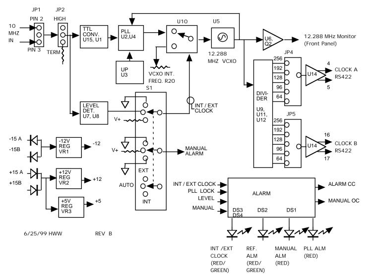
FIGURE 3.1 2099-42 BLOCK DIAGRAM
