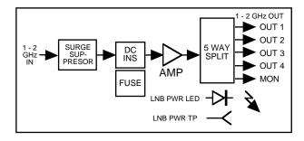
FIGURE 1.2 MODEL 1584-25 BLOCK DIAGRAM (EACH SPLITTER)
